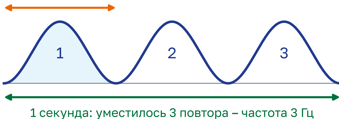
Рисунок 7.2 – Три одинаковых горба уместились в одну секунду: частота 3 Гц, а один горб длится треть секунды
