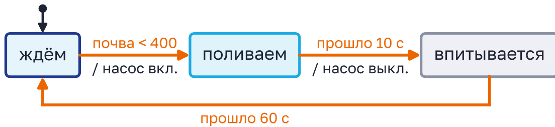
Рисунок 6.9 – Машина состояний «полив порциями». Чёрная точка показывает, с какого состояния машина начинает
