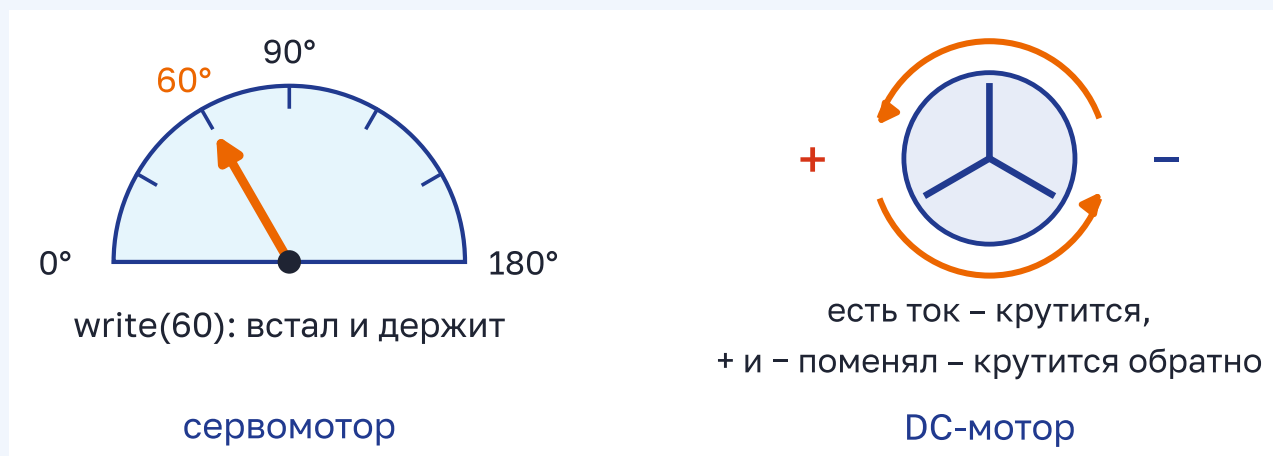
Рисунок 8.4 – Сервомотор встаёт на заданный угол и держит его. DC-мотор крутится, пока через него идёт ток
