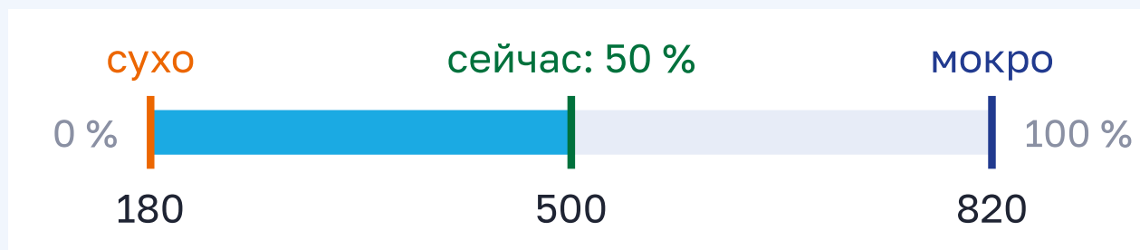
Рисунок 5.10 – Полоска от «сухо» (180) до «мокро» (820). Показание 500 стоит посередине – это 50 %
