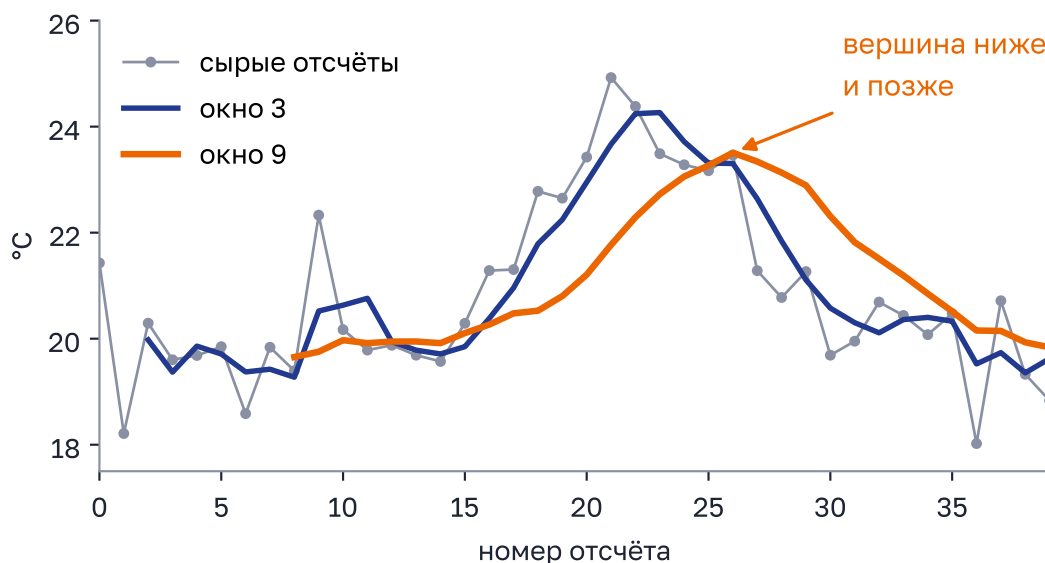
Рисунок 7.8 – Шумный ряд, сглаженный окном 3 и окном 9. Окно 9 глаже, но опаздывает и срезает вершину
