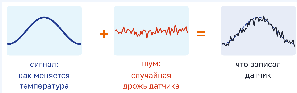
Рисунок 7.1 – Плавная линия плюс мелкая дрожь – получается то, что записал датчик
