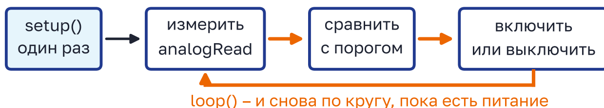
Рисунок 6.5 – setup() выполняется один раз, а loop() крутится по кругу, пока плата включена
