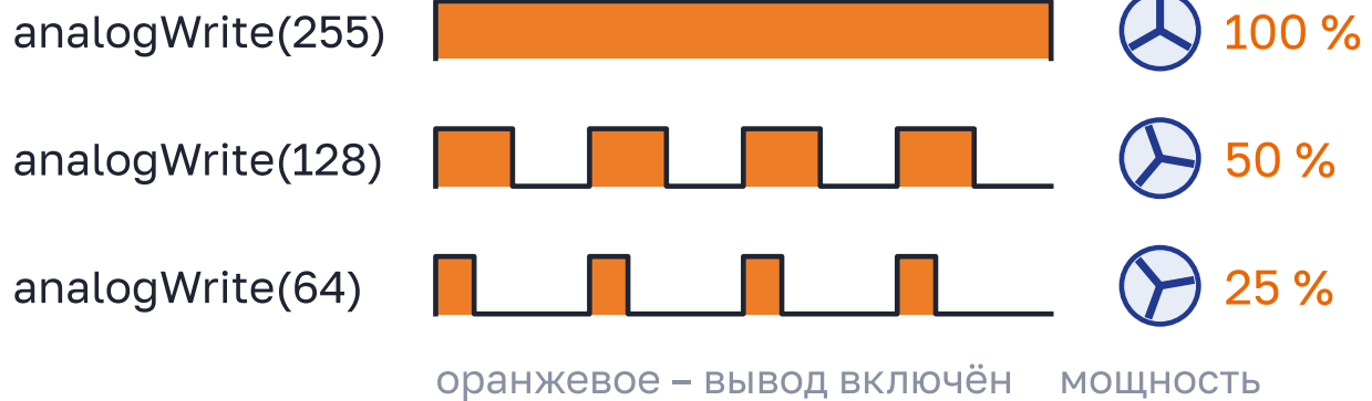
Рисунок 8.6 – Три команды analogWrite : вывод включён всё время, половину времени и четверть времени
