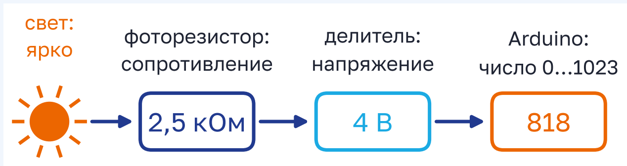
Рисунок 5.6 – Цепочка превращений: свет – сопротивление – напряжение – число
