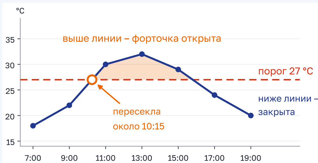
Рисунок 3.6 – График температуры и красная линия порога 27 °C. Кусок графика над линией закрашен
