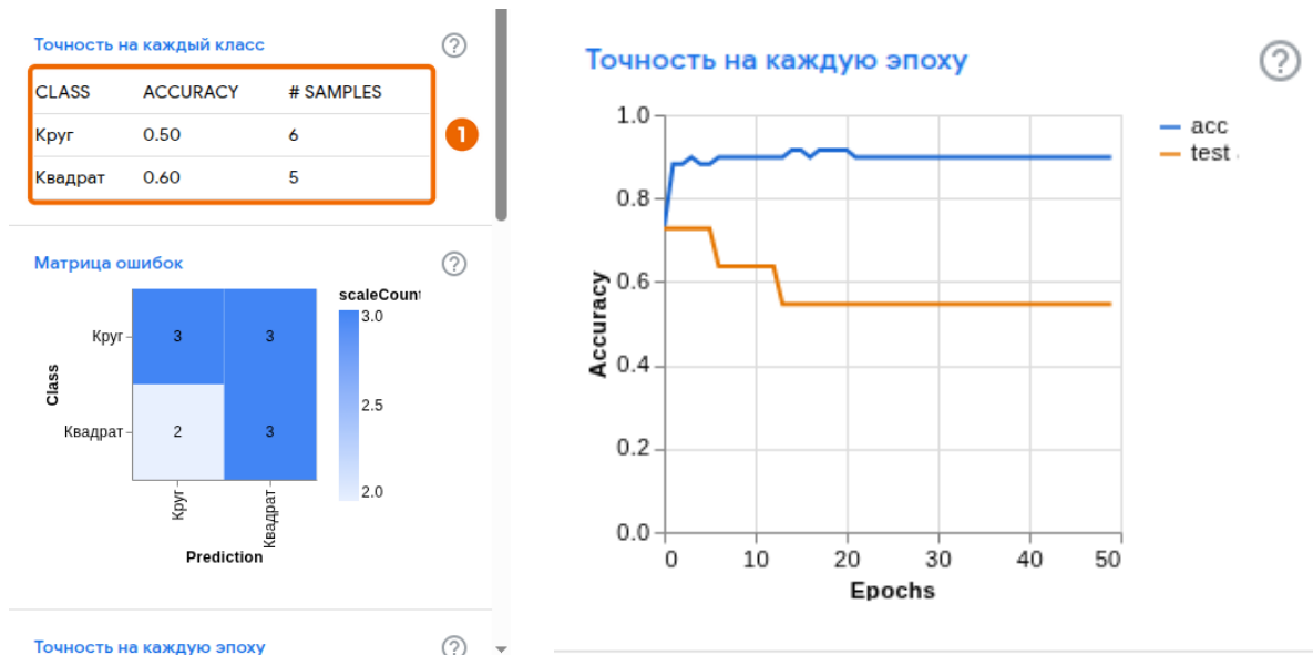
Рисунок В.48 – Испорченная модель: слева таблица и матрица ошибок, справа график точности – «test» ушла вниз от «acc»
