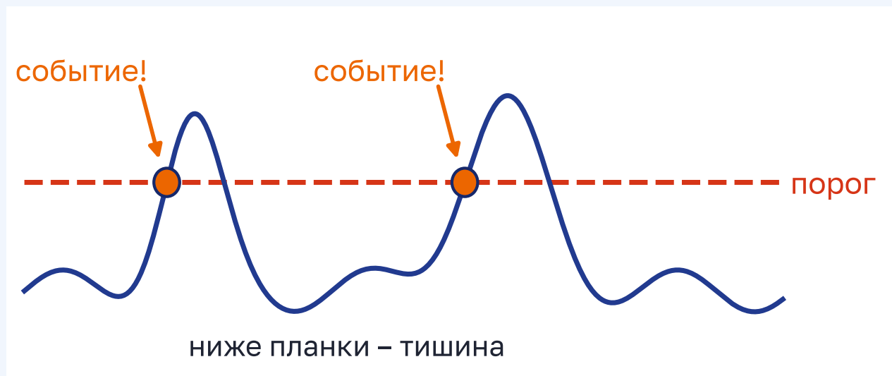
Рисунок 7.3 – Порог – как планка на прыжках в высоту. Событие случается в тот миг, когда сигнал перепрыгнул планку
