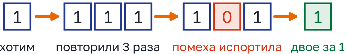
Рисунок 5.8 – Каждый бит послали трижды. Помеха испортила один из трёх – приёмник всё равно понял
