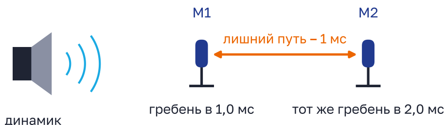
Рисунок 2.14 – Звук от динамика сначала доходит до первого микрофона, потом до второго
