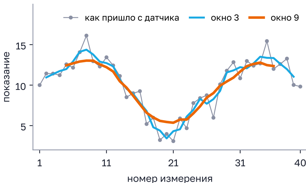
Рисунок 3.8 – Одни и те же показания, сглаженные окном 3 и окном 9. Окно 3 убрало мелкие зубцы, но линия ещё неровная. Окно 9 сгладило почти всё, зато вершины волны стали ниже, а с краёв пропало по четыре числа
