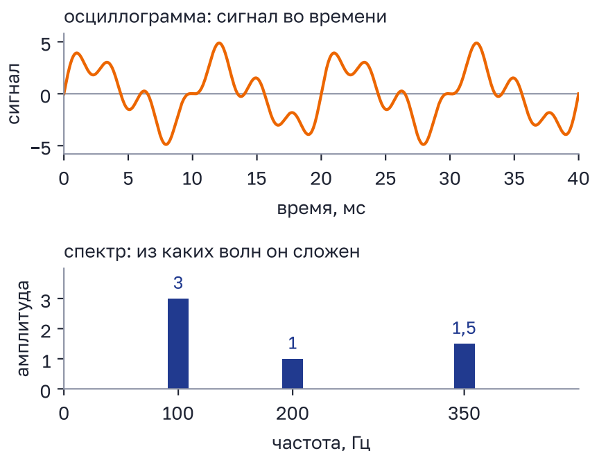
Рисунок 3.4 – Один сигнал двумя способами. Сверху – как он меняется во времени, снизу – из каких волн он сложен: 100 Гц с амплитудой 3, 200 Гц с амплитудой 1 и 350 Гц с амплитудой 1,5
