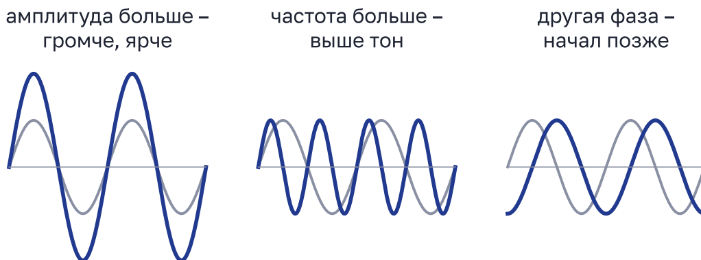
Рисунок 2.5 – Серым – один и тот же исходный сигнал. Синим – что будет, если увеличить амплитуду, увеличить частоту или сдвинуть фазу
