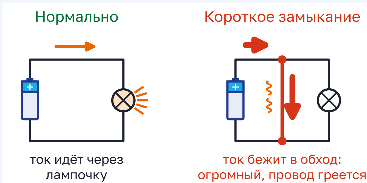
Рисунок 6.6 – Короткое замыкание: ток пошёл в обход лампочки
