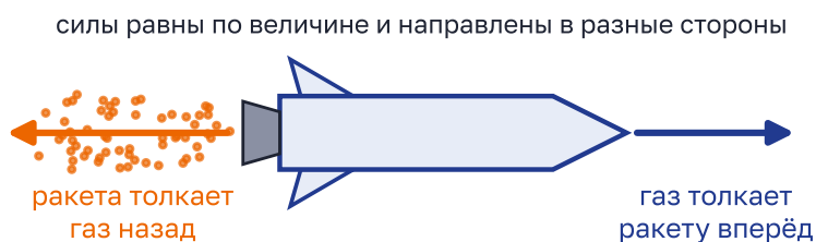
Рисунок 2.5 – Реактивное движение: ракета толкает газ назад, газ толкает ракету вперёд
