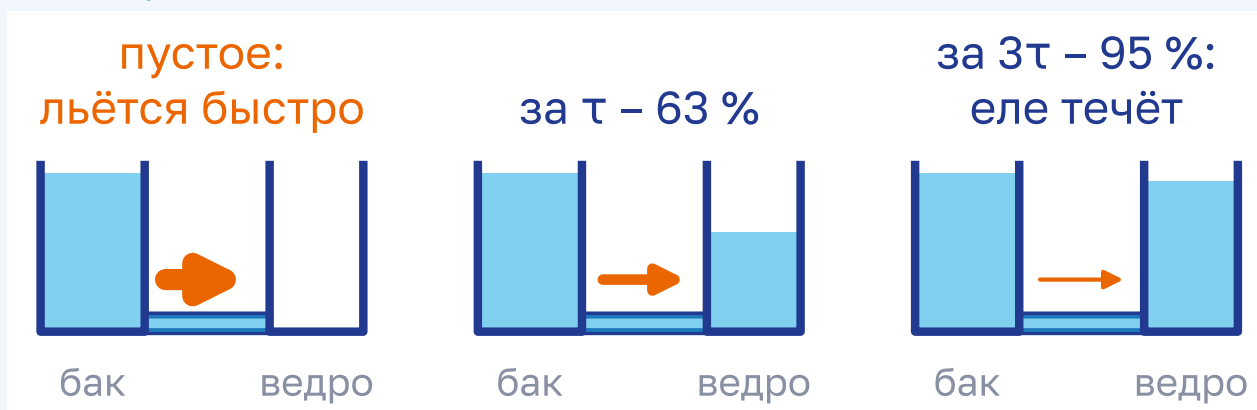
Рисунок 6.13 – Бак и ведро, соединённые трубкой
