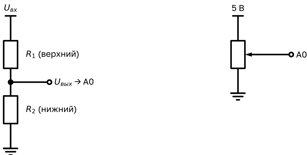
Рисунок 6.10 – Слева – делитель из двух резисторов: U_{\text{вых}} снимают с точки между ними. Справа – потенциометр: тот же делитель, но движок можно передвигать
