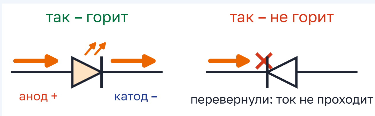
Рисунок 6.7 – Светодиод пропускает ток только в одну сторону
