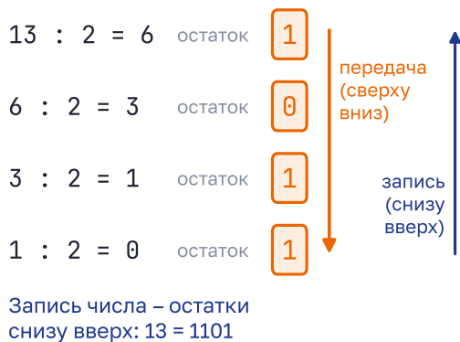
Рисунок 7.6 – Перевод 13 в двоичную систему делением на 2 и порядок передачи «младшим битом вперёд»
