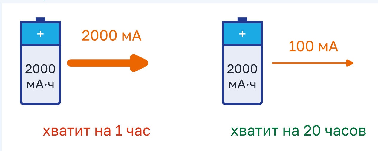
Рисунок 6.15 – Одна и та же батарейка при большом и маленьком токе
