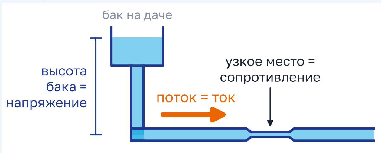
Рисунок 6.1 – Ток – как вода в трубе
