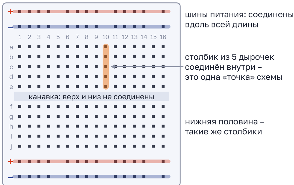
Рисунок 6.18 – Макетная плата. Каждый столбик из 5 дырочек соединён внутри, длинные шины по краям – вдоль всей длины
