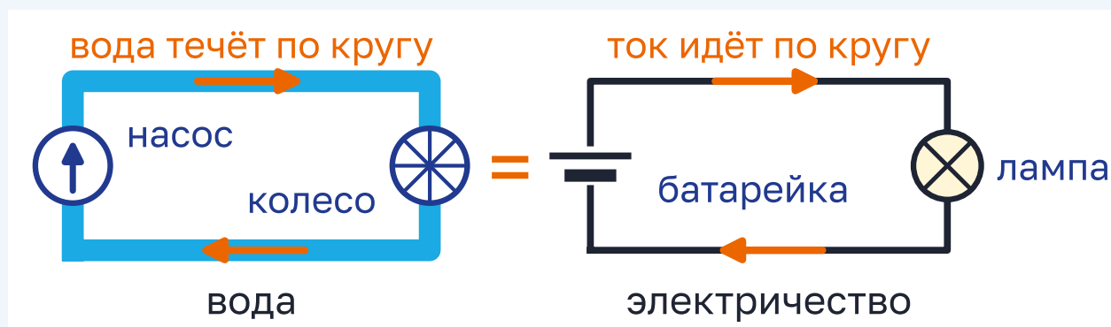
Рисунок 5.1 – Вода в трубах и ток в проводах устроены одинаково
