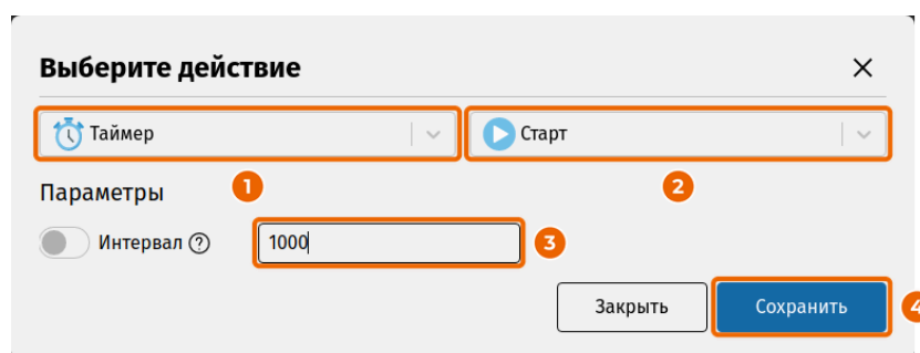
Рисунок В.17 – Действие «Таймер – Старт» на 1000 мс
