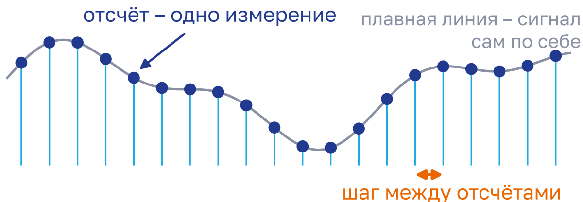
Рисунок 4.3 – Плавная линия – сигнал. Точки – то, что успела измерить плата
