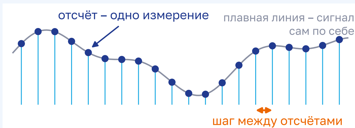
Рисунок 4.3 – Плавная линия – сигнал. Точки – то, что успела измерить плата
