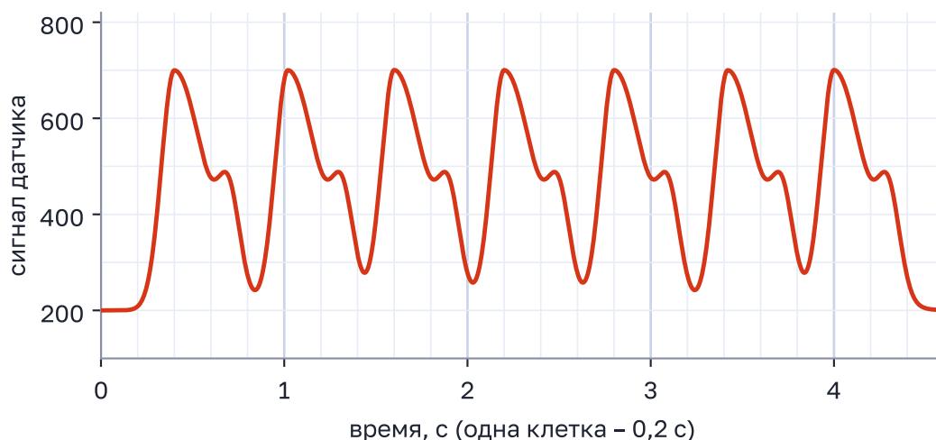
Рисунок 2.11 – Запись оптического датчика пульса. По горизонтали время, одна клетка – 0,2 с
