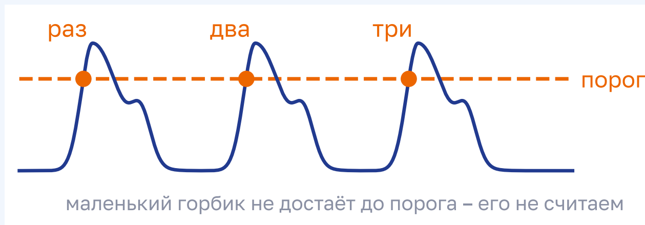
Рисунок 4.5 – Порог – планка поперёк графика. Засчитываем удар, когда сигнал перелез через неё снизу вверх
