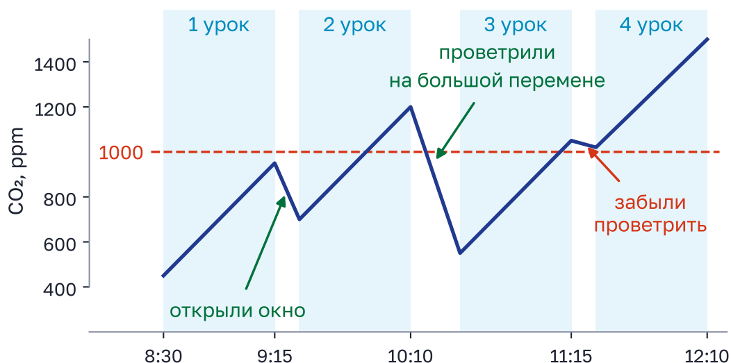
Рисунок 7.5 – CO 2 в одном кабинете за четыре урока. Пунктир – порог 1000 ppm
