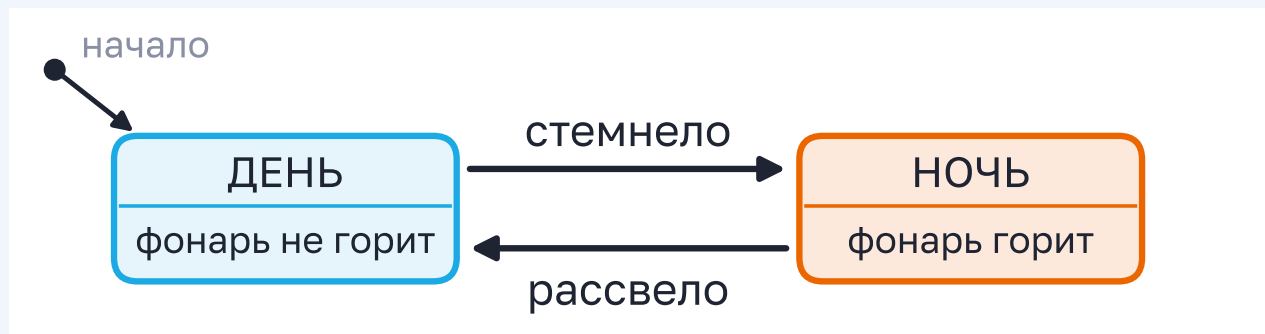
Рисунок 6.8 – Уличный фонарь с датчиком света: два состояния и два события
