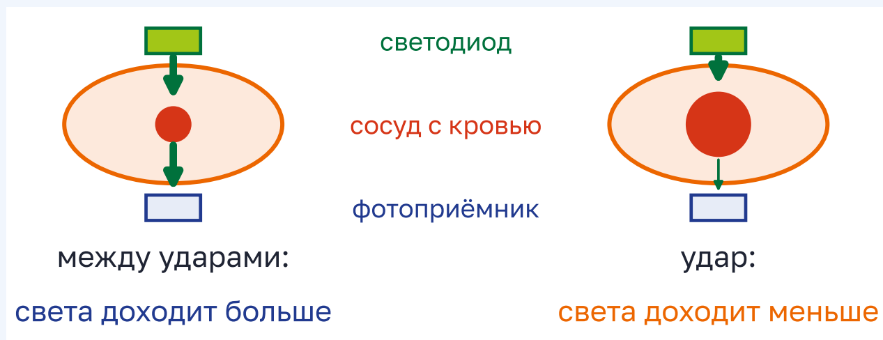
Рисунок 2.10 – Светодиод светит сквозь палец, фотоприёмник ловит, сколько света прошло
