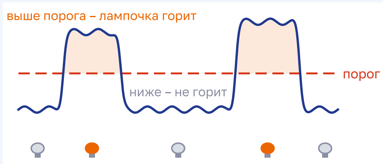
Рисунок 3.3 – Огибающая ЭМГ и порог. Пока линия выше порога, лампочка горит
