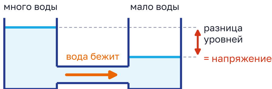
Рисунок 1.10 – Напряжение – как разница уровней воды. Чем больше разница, тем сильнее напор в трубке
