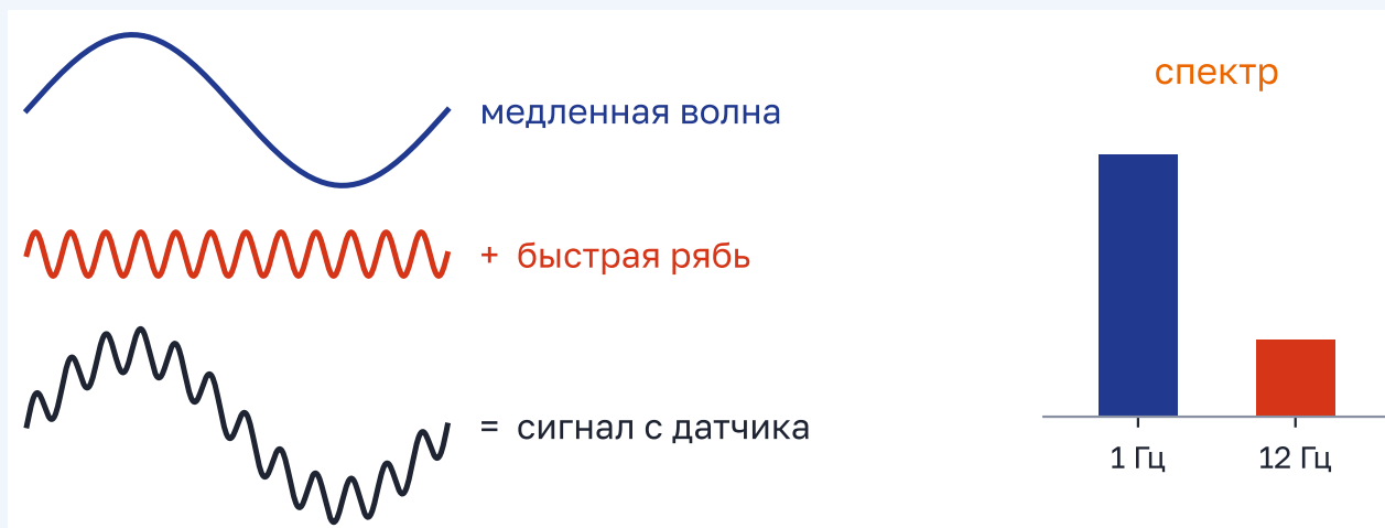
Рисунок 4.11 – Сложный сигнал раскладывается на простые волны. Спектр показывает, какие в нём частоты и сколько каждой
