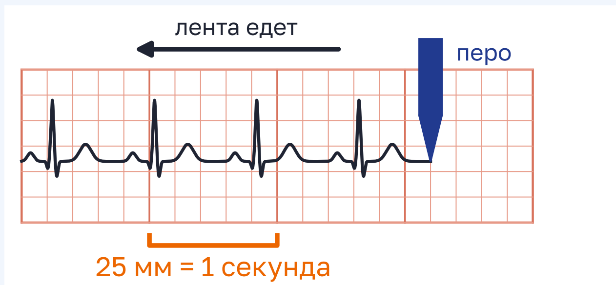
Рисунок 2.4 – Лента едет под пером с постоянной скоростью, перо рисует удары
