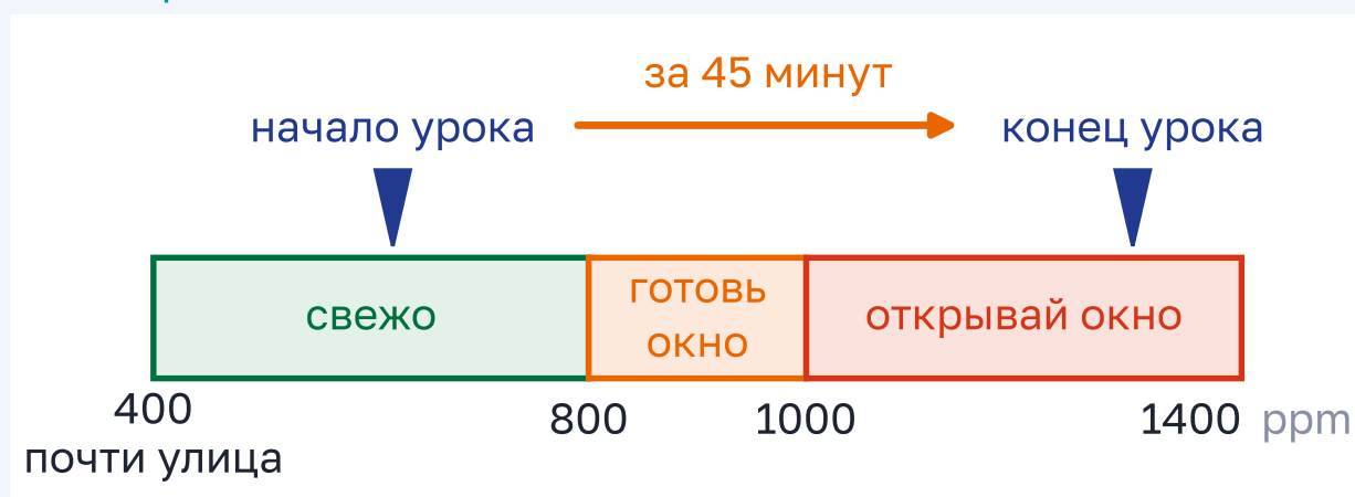
Рисунок 7.4 – Шкала датчика CO 2 : зелёная, оранжевая и красная зоны
