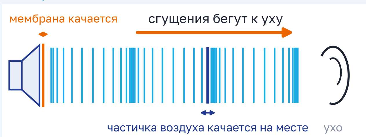
Рисунок 8.2 – Мембрана динамика толкает воздух. Сгущения бегут к уху, а каждая частичка воздуха только качается на месте
