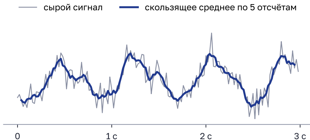
Рисунок 4.10 – Шумная пульсовая волна и она же после скользящего среднего по 5 отсчётам
