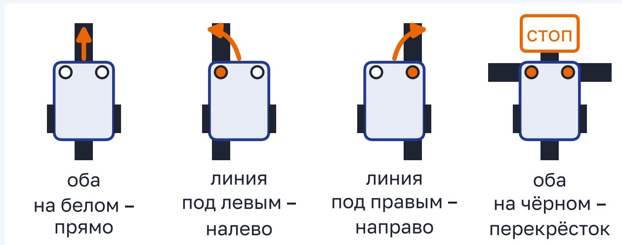
Рисунок 7.3 – Четыре случая: оба датчика на белом, линия под левым, линия под правым, оба на чёрном
