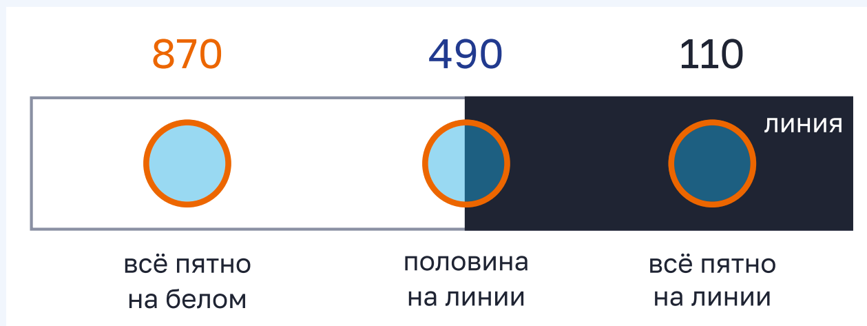
Рисунок 7.1 – Пятно света датчика съезжает с белого поля на чёрную линию
