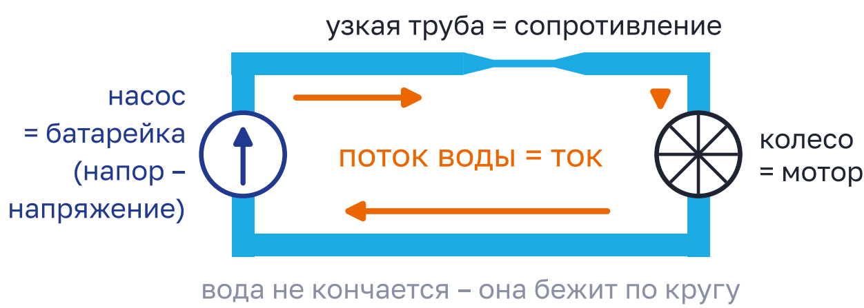
Рисунок 5.1 – Ток бежит по проводам, как вода по трубам, замкнутым в кольцо
