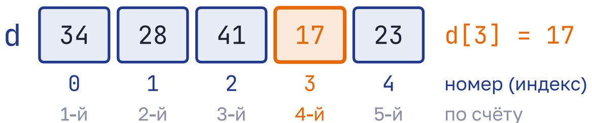
Рисунок 6.8 – Массив – ряд пронумерованных ящиков под одним именем
