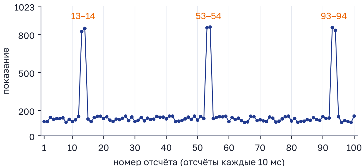
Рисунок 8.15 – Показания датчика у колеса к задаче 8.5. Подписаны номера отсчётов, где видна метка
