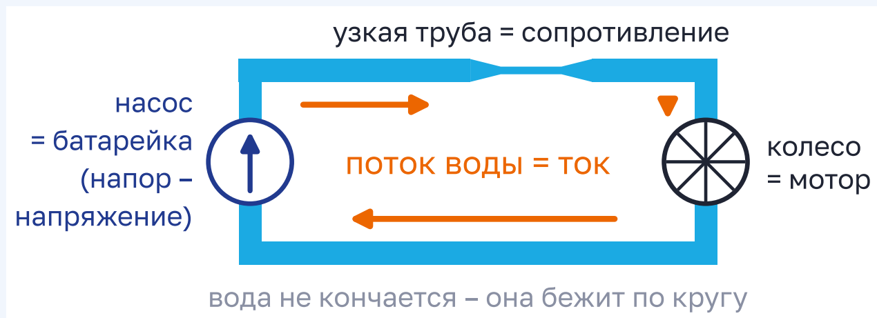
Рисунок 5.1 – Ток бежит по проводам, как вода по трубам, замкнутым в кольцо
