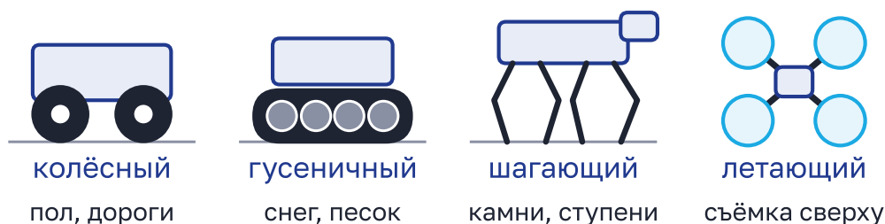
Рисунок 1.2 – Какие бывают мобильные роботы. Подписи внизу – где такой способ движения выручает
