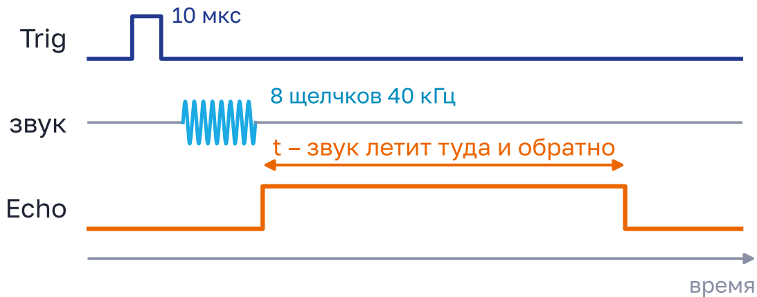
Рисунок 5.13 – Сигналы дальномера во времени. Длительность сигнала на Echo – время полёта звука туда и обратно
