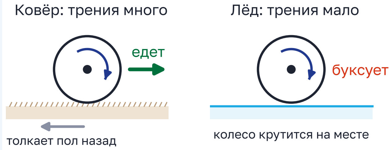
Рисунок 2.9 – Одно и то же колесо на ковре и на льду
