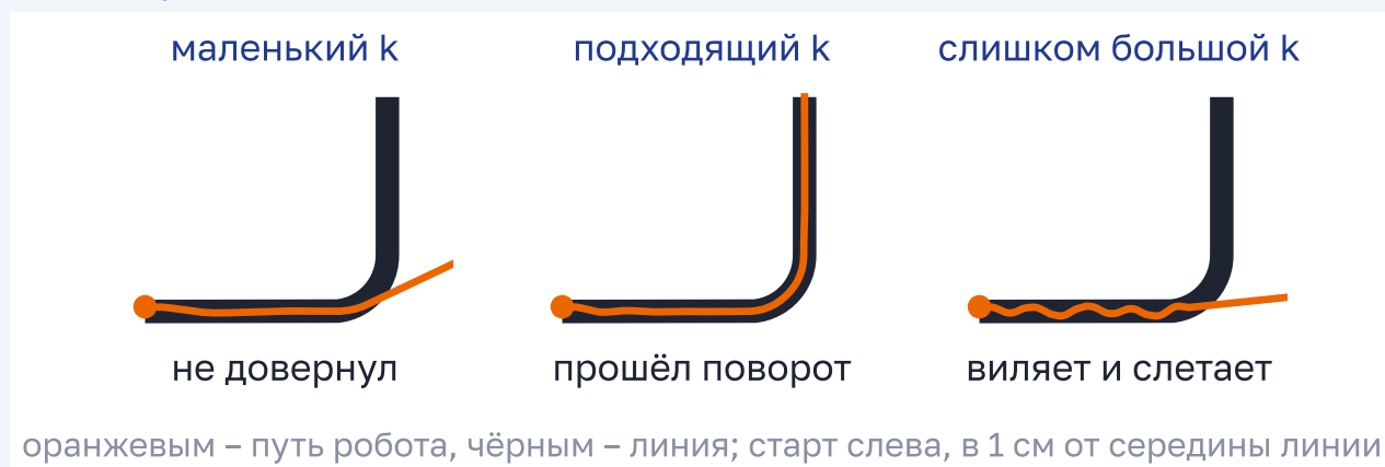
Рисунок 7.8 – Три робота с разным коэффициентом на одном и том же повороте
