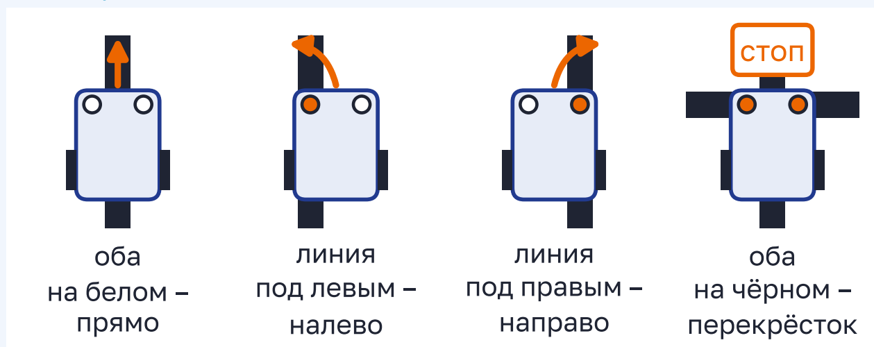
Рисунок 7.5 – Четыре случая: оба датчика на белом, линия под левым, линия под правым, оба на чёрном
