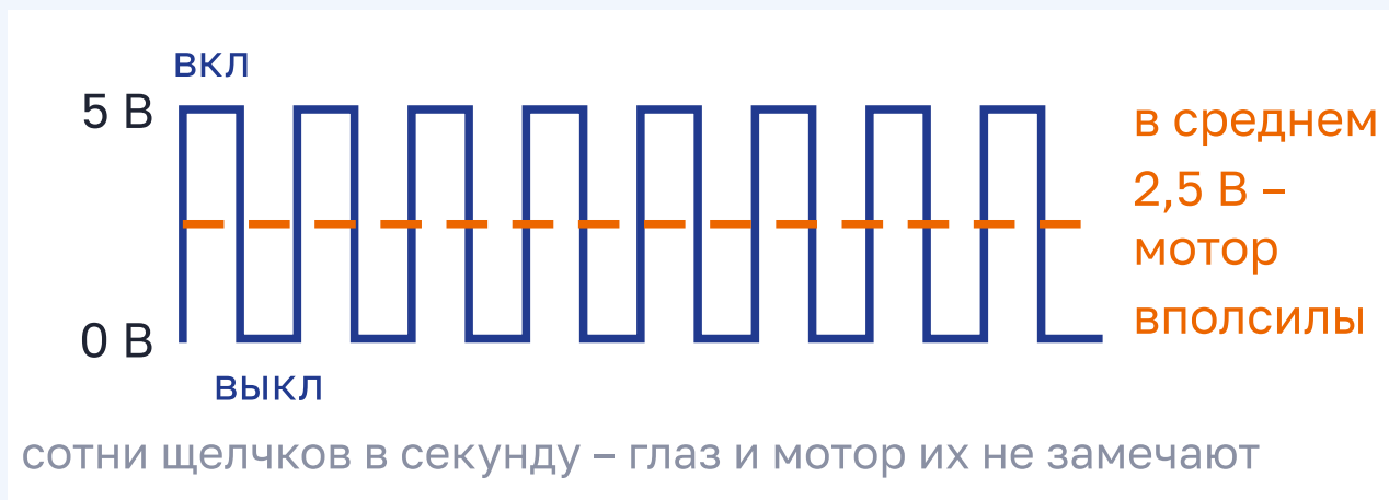
Рисунок 5.7 – ШИМ: вывод быстро-быстро щёлкает между 5 В и 0 В
