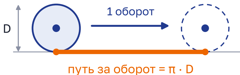
Рисунок 1.12 – Колесо сделало один оборот. Метка на ободке снова внизу, а за колесом осталась «размотанная» полоска длиной \pi \cdot D
