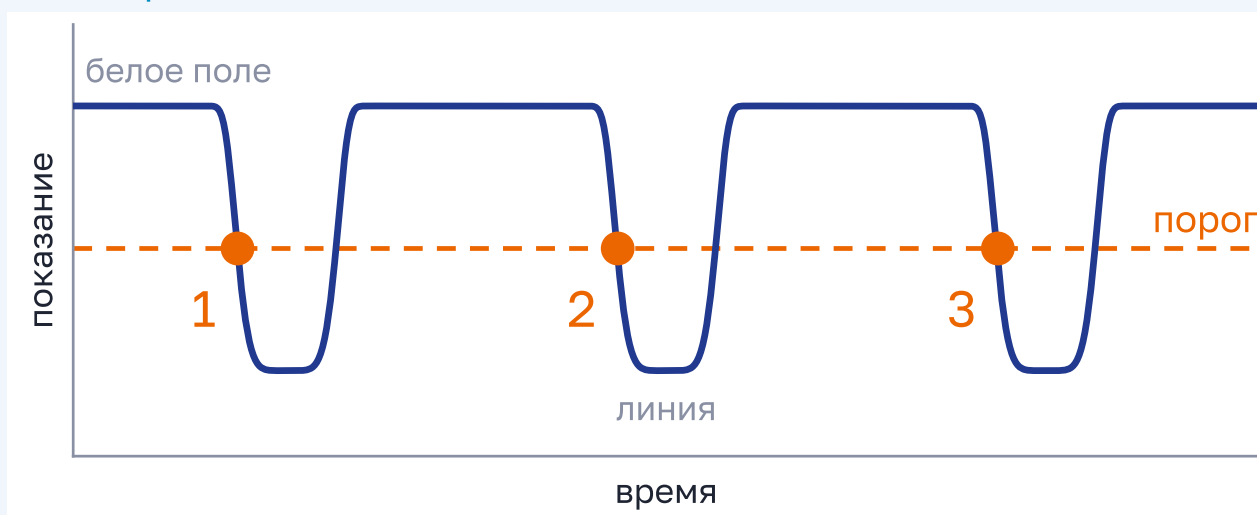
Рисунок 8.8 – Считаем моменты, когда сигнал нырнул под порог
