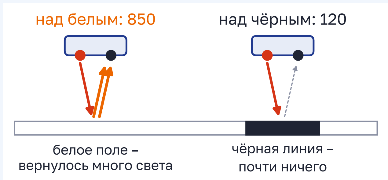
Рисунок 5.11 – Датчик линии над белым полем и над чёрной линией
